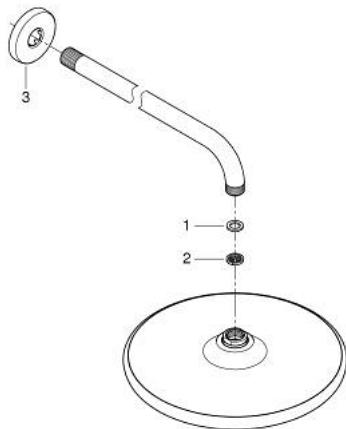
1: Joint fibre 15x21 (Numéro de commande 0138900M)
